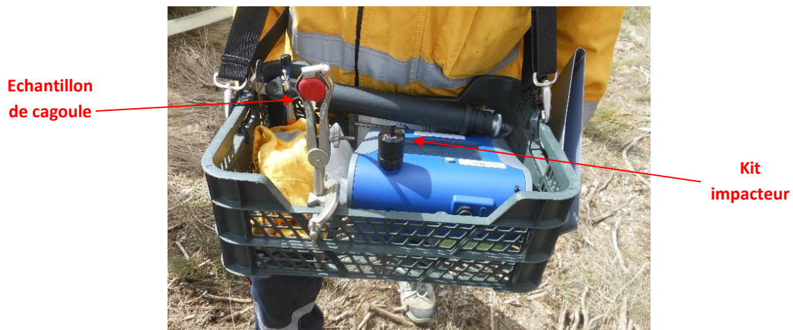
Fig.51 : Appareil Dustrak portable pour la mesure des particules fines en condition de terrain
