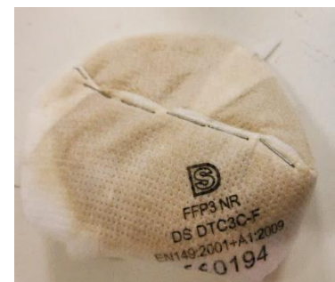
Fig. 35 : Encrassement du masque anti-poussières FFP3 après utilisation
