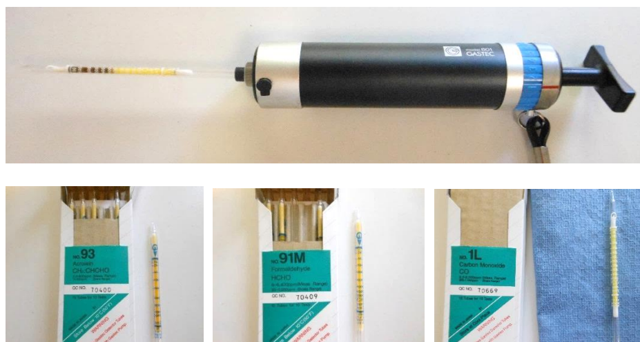
Fig.10 : Pompe de prélèvements et tubes colorimétriques GAZDETECT
