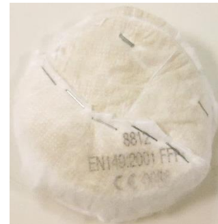
Fig. 31 : Encrassement du masque anti-poussières FFP1 après utilisation
