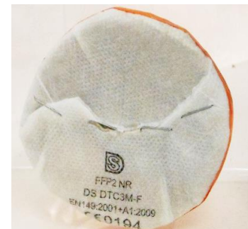
Fig. 33 : Encrassement du masque anti-poussières FFP2 après utilisation
