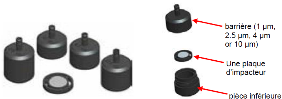
Fig.12 : Éléments de séparation des fractions de coupe du « Kit impacteur »
