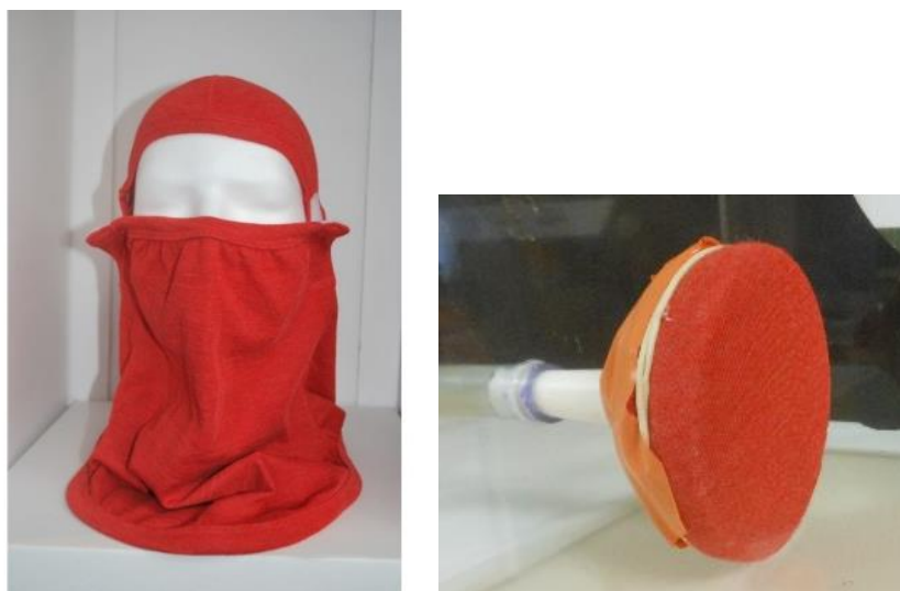
Fig.2 : Cagoule feu de forêts découpée pour les besoins de l'expérimentation
