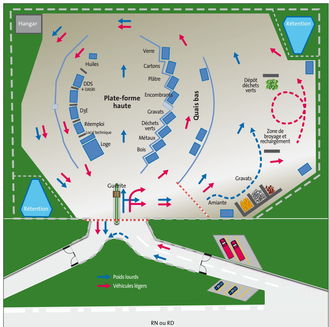
Figure 5. Exemple de plan de circulation des poids lourds et des véhicules légers dans une déchèterie
